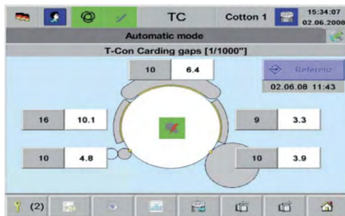
شکل ۲- تفاوت تنظیم در شرایط سرد و گرم کاردینگ
