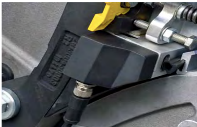
شکل ۱- اندازه گیری دمای سیلندر با استفاده از سنسور غیرتماسی
